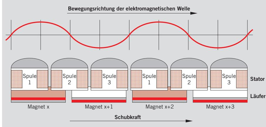
Der DC-Linearmotor (permanentterregter Synchron-Linearmotor) erzeugt die an eine Schiebetür angepasste Bewegung.
