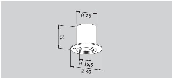
**Bodenlager mit Rundachse**
