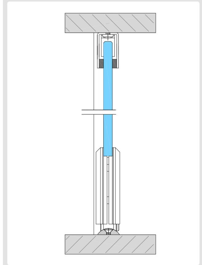
1-tlg. Führungsprofil Standard/im Lieferumfang
