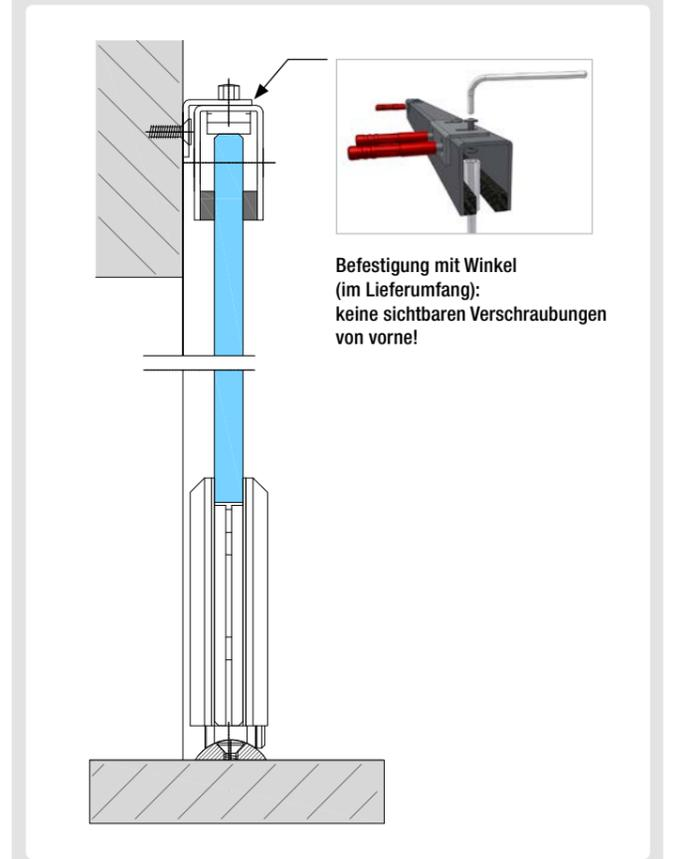
1-tlg. Führungsprofil Standard/im Lieferumfang
