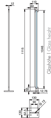
Geländerpfosten - mit U-Profil oben / U-Profil unten Balustrade posts with U-Profiles on the upper and lower edges
